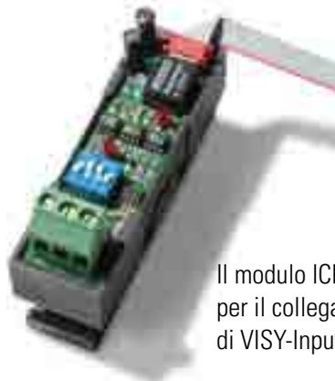
Il modulo ICI-485 necessario per il collegamento di VISY-Input/VISY-Output
